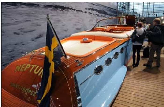
Mässans fräckaste motorbåt var svenska J Craft Torpedo. Den har en tidlös stil och en modern framdrivning med två Volvo Penta IPS 500 motorer, som ger den 12,63 m långa båten en toppfart på 44 knop. www.j-craftsboats.com
