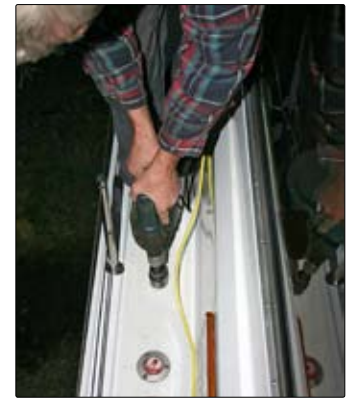
Nytt hål i däck för sugtömningen.
