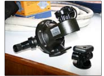
En kraftig membranpump sköter utpumpningen till havet.
