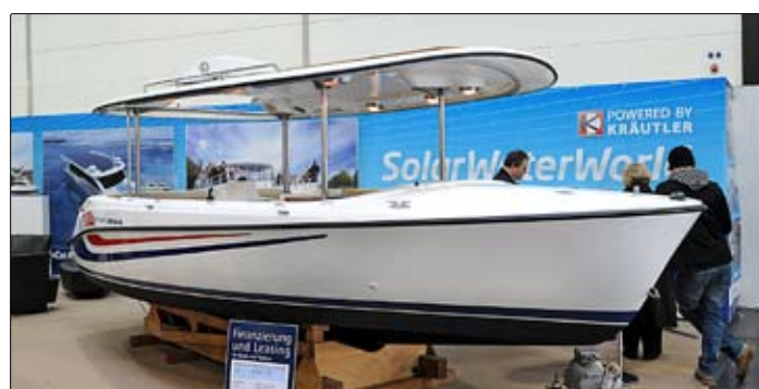
Lear 204 är en USA-båt med solceller på taket. Båten är på 6,10x2,59 m, väger 1 225 kg och har en 36V elmotor. Fart 6 knop. www.lear-electric-boats.com
