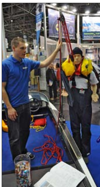
Att lyfta upp en person som har trillat i vattnet är tungt. Mob.Ysport är det kryptiska namnet på denna smarta hävstång som monteras till exempel på en knop. www.mob-y.de
