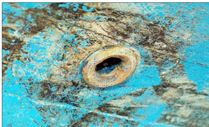
Dåliga skrovgenomföringar, slangar och slangklämmor får fortfarande flest anmärkningar vid säkerhetsbesiktningen.
