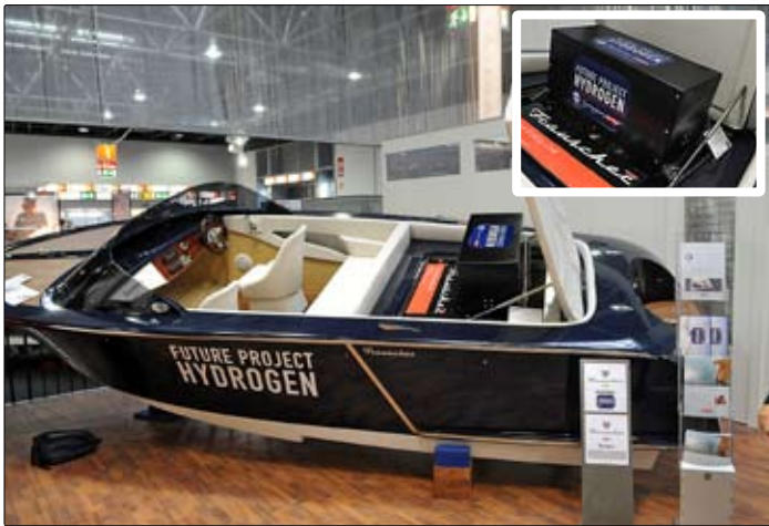
Frauscher Riviera 600 är inte färdig för serieproduktion men har en intressant framdrift. Båtens batterier laddas via bränslecell och utsläppen är därmed helt rena. www.futureprojecthydrogen.com
