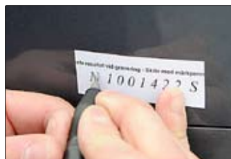
Den synliga märkningen graveras in med tryckluft och en fin märkpena.
