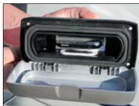
SonicHub är ett modernt ljudsystem som använder iPhone, iPod eller andra mp3-spelare som ansluts via USB-uttag.
