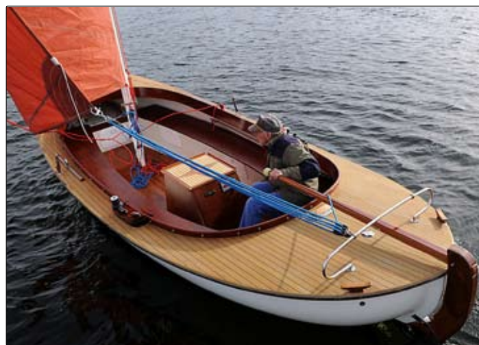
Sprisegel är ett smidigt och enkelt alternativ som har många fördelar. Riggen blir inte så hög och det finns ingen bom som kan slå i huvudet. På den här båttypen passar det väldigt bra.
