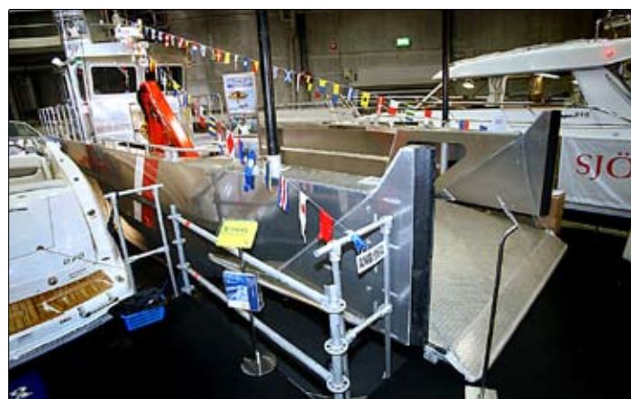
Kanadensiska Stanley Boats hade svensk premiär på mässan. Den här modellen heter Landingcraft 40. Den byggs helt i aluminium av hög marinkvalité och finns i åtta olika storlekar på 22–40. Bottenplåten är 6,25 mm tjock och däckat på Bullsnose 40" är 37 m 2 . Båten lastar upp till 9 ton. Rekommenderade motorer är 2xVolvo Penta D6 280 hk. www.stanleyboats.se
