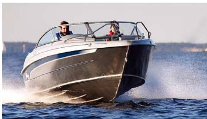
Skroven är en vidareutveckling av motsvarande Yamarinbåtar i glasfiber. Med ett antal förändringar av bland annat steglisterna är skroven i aluminium ännu vassare och tystare.
