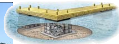
Principen för den nya sortens brygggor med extremt lång livslängd är glasfiber för delar under vattnet.
