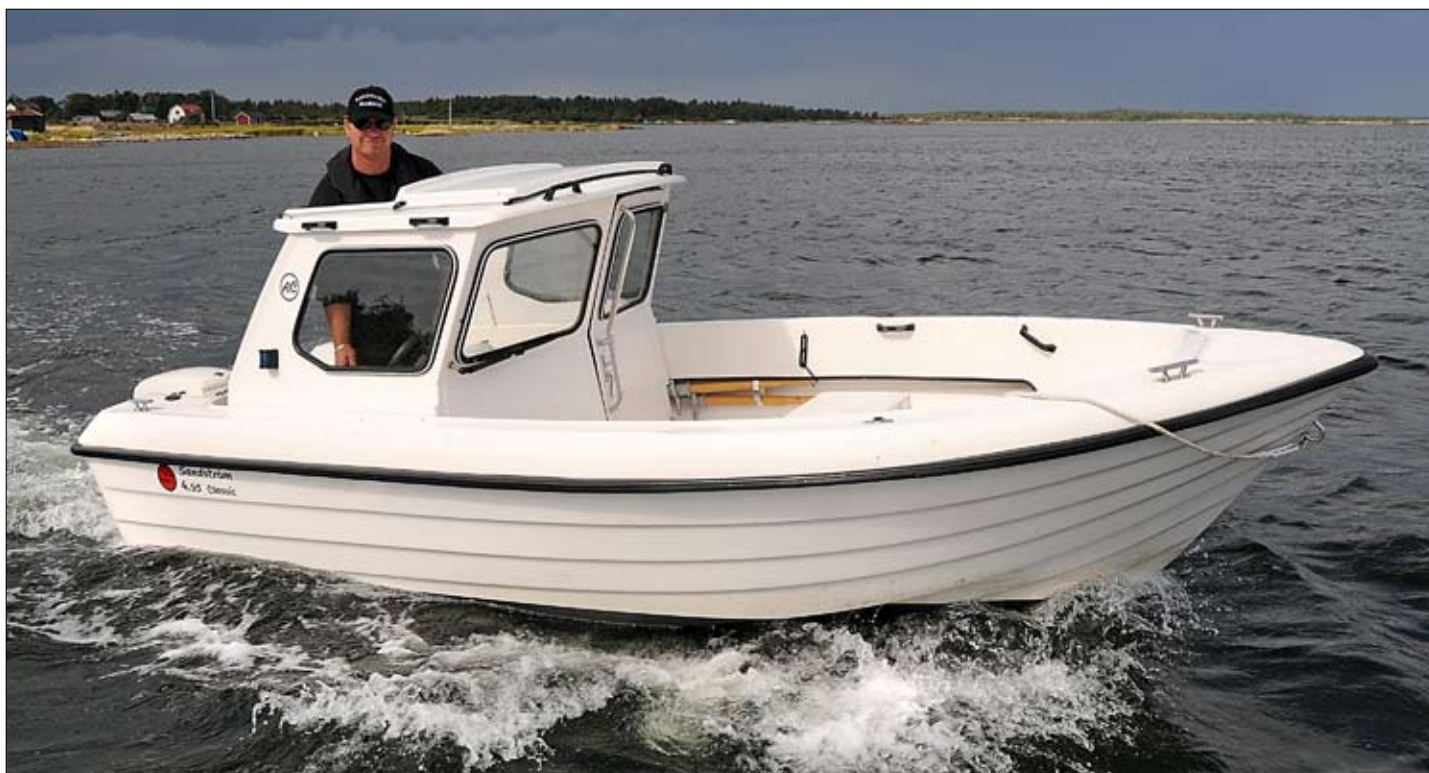
Sandström 4.95 AC är en klassisk kabinbåt på 4,95x1,95 m. med en 50 hk utombordare gör den 30 knop.
