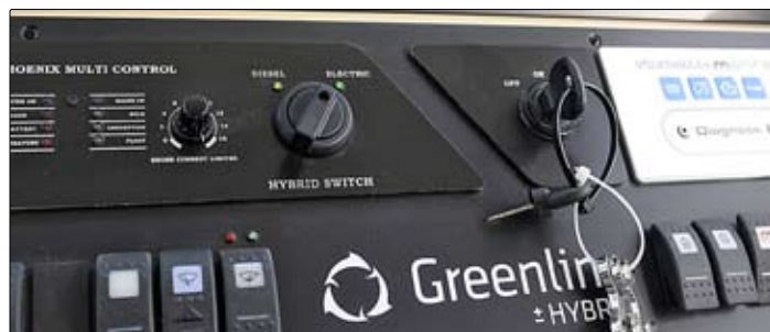
Föraren väljer mellan dieseldrift och eldrift med ett vred på instrumenttavlan.
