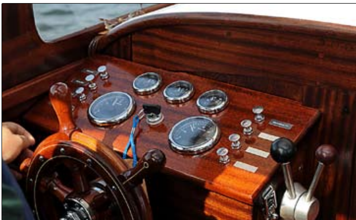
Instrumentbrädan är nytillverkad och försedd med nya VDO Viewline-instrument.
