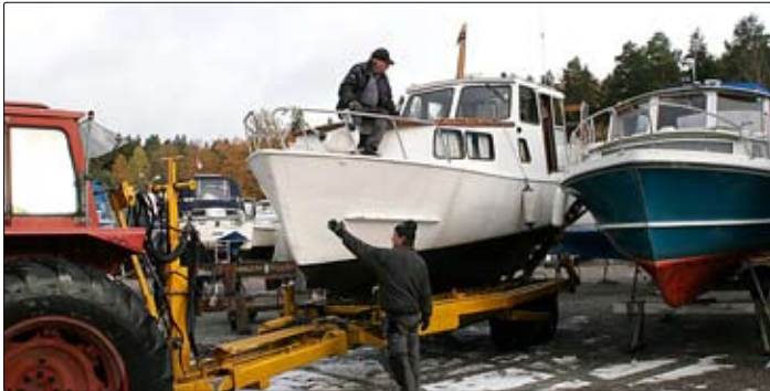
Tack vare att vagnen är ledad går det lätt att "fickparkera".
