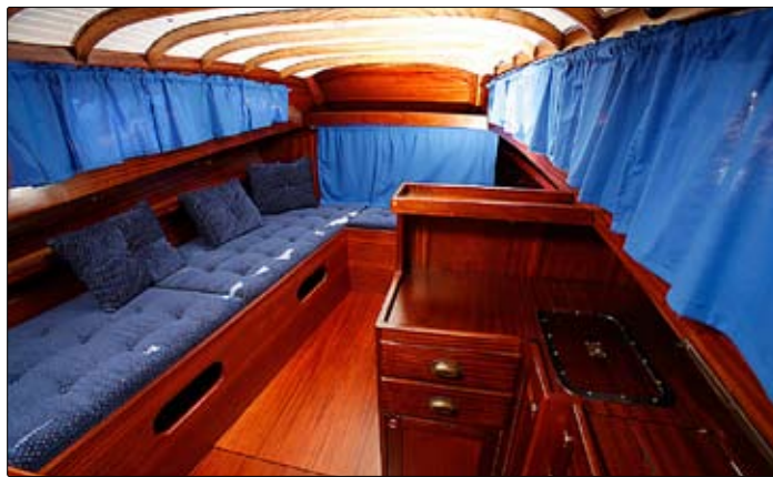
Ruffen efter massor av skrapning och slipning och många lager ny fernissa.
