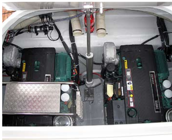
Volvo Penta D4-260 EVC (2x260 hk) i motorrummet.
