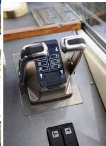
Det nya, elektroniska reglaget på plats. Reglaget är kopplat till motorerna via en databox.
