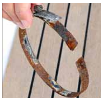
Den här slangklämman höll på att sänka Båtlivs Saltö 31.
