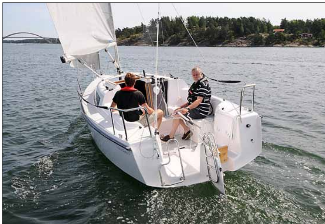
Den här båten är kompletterad med olika tillval, bland annat racingsegel som är cirka 3 m 2 större än standard. Kölen sitter i en kassett och med den uppfälld blir båten helt slät under när den ska tas upp och trailas eller vinterförvaras.
