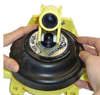
Steg 8 – Försäkra dig om att alla delar sitter ordentligt fast och att slangklämmorna sitter ordentligt.
