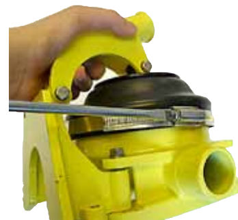
Steg 1 – Slacka och avlägsna slangklämman för att frigöra membranet. Använd en vanlig flat skruvmejsel eller (helst) en slangklämskruvmejsel.
