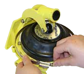
Steg 9 – Kolla slutligen att pumpens ytskikt är OK. Annars bör du bättra med lite färg. Efter det återstår bara att montera tillbaka den i båten.
