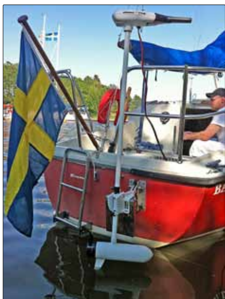
Sommarens utropstecken, den vita Minn Kota Riptide-motorn på 36 V. ”Rippen” blev en pålitlig och tystlåten vän.
