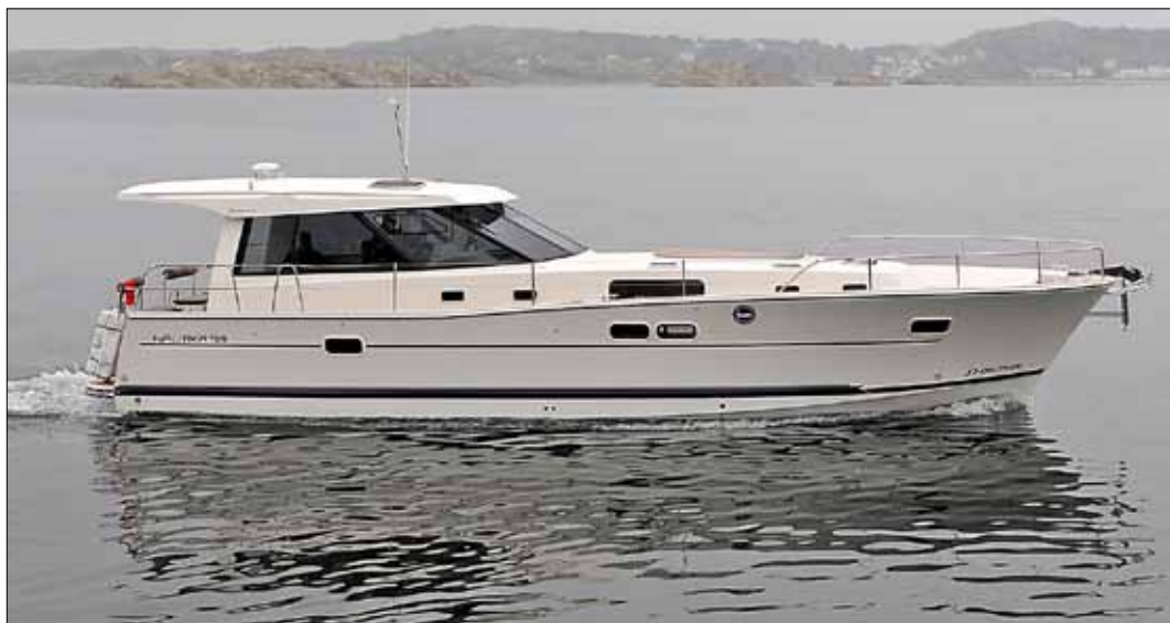
Delphia 1350 är en rymlig motorbåt på 13,5 m med en dieselmotor på endast 50 hk. Det ger en bränsleförbrukning näst intill i snipklass med 0,75 lit/Nm.
