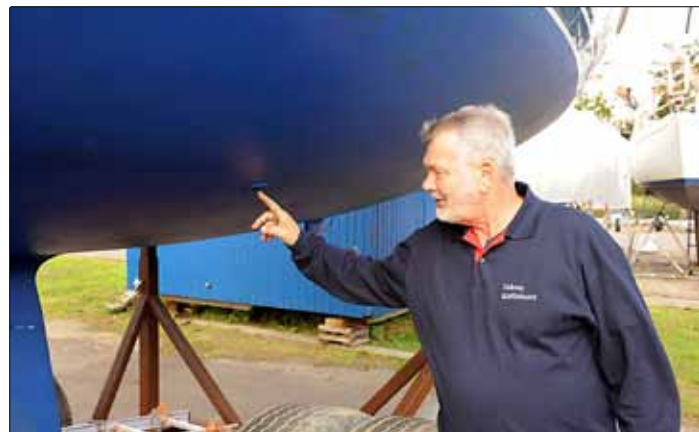
Skrovgenomföringar är en klassisk kontrollpunkt för att få en säkrare båt.
