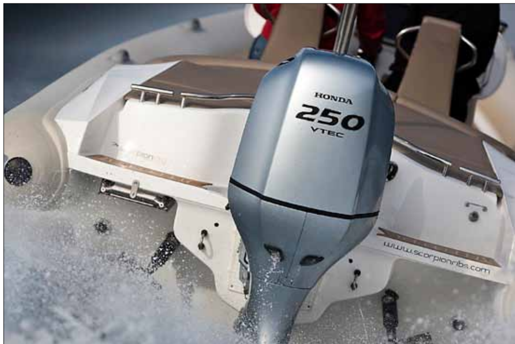
Hondas nya toppmodell BF250 är en ny 3,6-liters V6-motor med världens första system för direktluftinsugning för utombordare. Den lanseras i den nya färgen Aquamarine Silver Metallic och en ny yttre design. Foto: Paul Wyeth.
