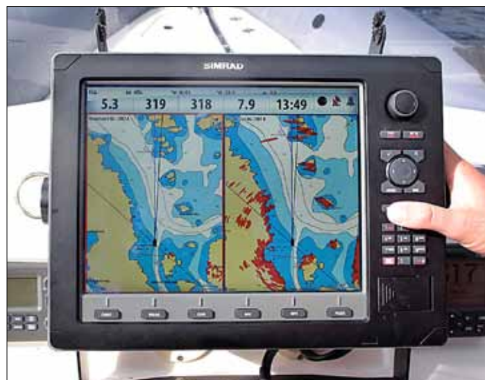
Navico 4G radar ger en utmärkt och tydlig bild både som separat radar och som radaröverlägg i en kartplotter. Räckvidden är 50 procent bättre mot föregående generation. Pris ca 25 000 kr.
