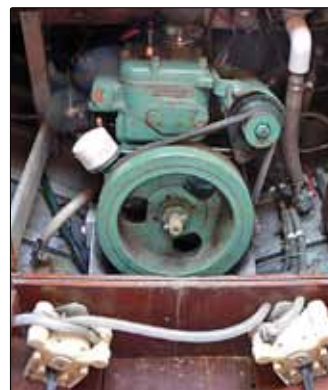
Trotjänaren som skall ersättas av en VP-diesel. Den senare väger 60 kg mer än bensinmotorn, vilket är ett av alla skäl till att skapa mer lyftkraft i aktern genom skrovförlängning.
