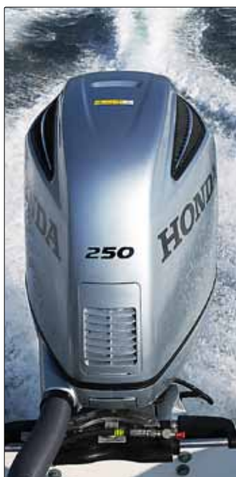
Här syns tydligt luftintaget på motorkåpans framsida och den nya, slimmade designen.
