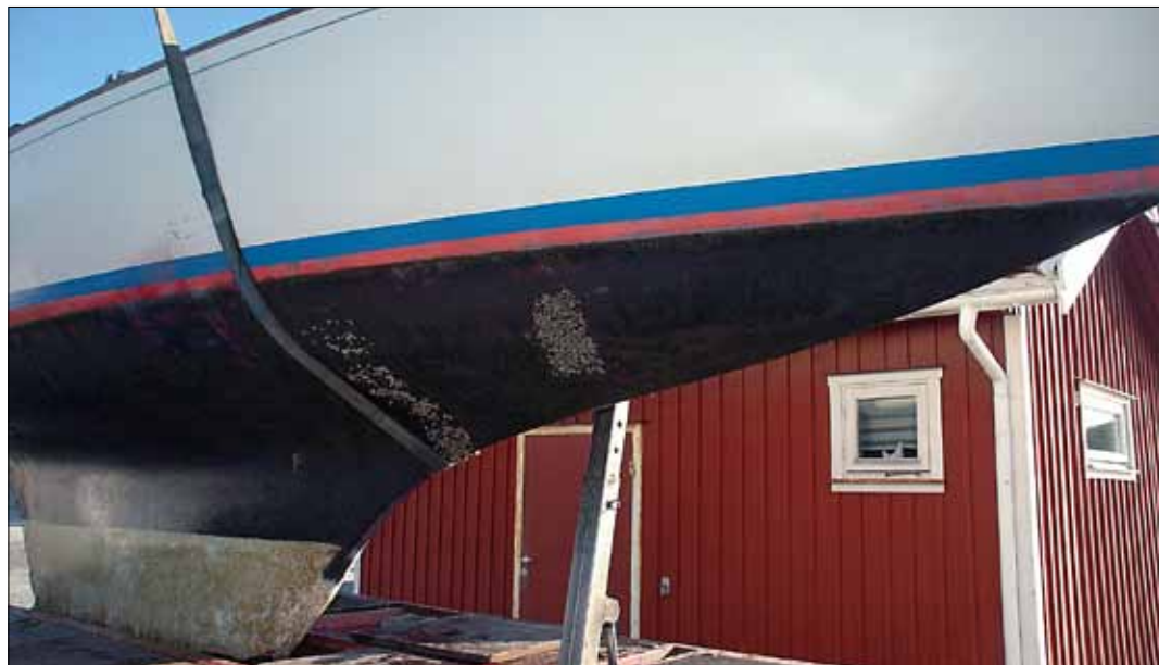
Skrovet var efter tre år i sjön helt fritt från havstulpaner utom på de kontrolltytor som syns på bilden.
