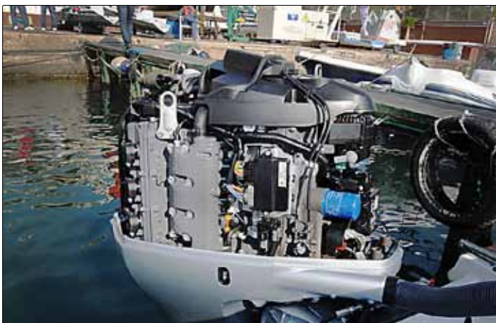
På styrbordssidan syns den elektroniska ECU:n (motorstyrenheten) tydligt.
