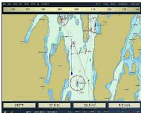
På den delade displayen har rörliga ekon på radarn röd färg medan landkonturer och fasta ekon har gul färg.
