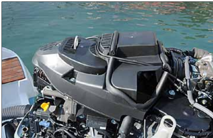
Under plastkåpan på motorns övre del syns kanalerna för kylflödet. Under kåpan sitter en fläkt som hjälper till att dra in luft.
