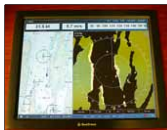
Ett exempel på hur SeaCross system delar upp bilden på två sjökortsbilder.
