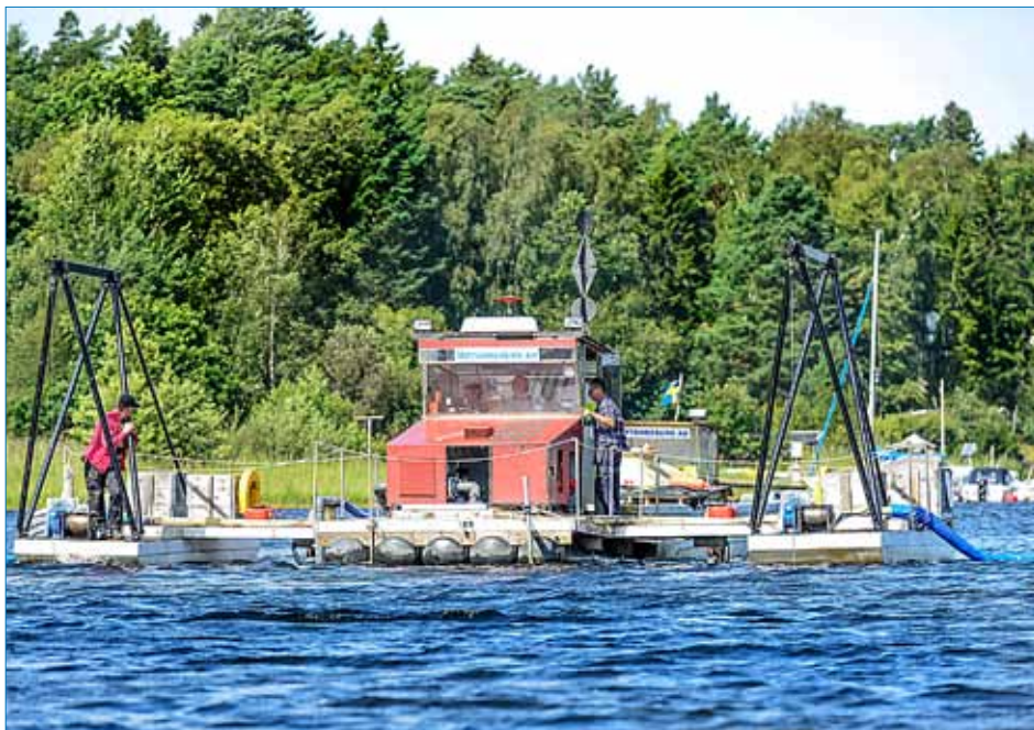
Fällningsbåten i Säbyviken. Foto: Fredrik Wulff.
