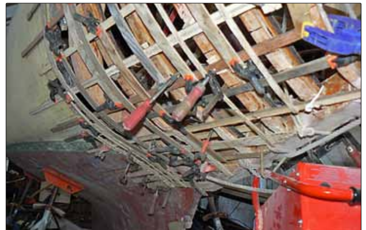
4. Horisontella och vertikala ribbor visar att turningen stämmer.
