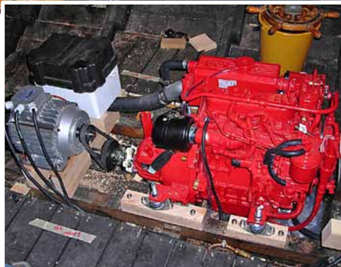
Det nya motorarrangemanget med en diesel och en elmotor.
