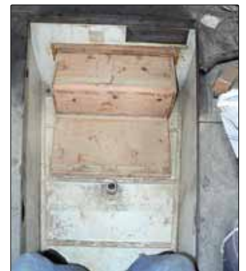
6. Den nya durkluckan med sitt inbyggda trappsteg.
