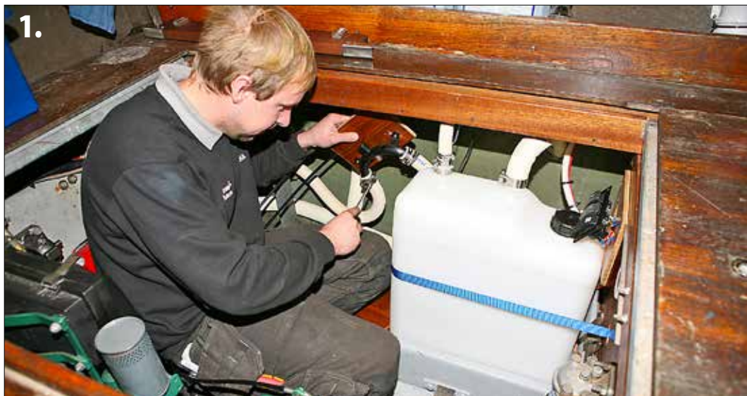
1. Nästan hela toalettsystemet (förutom själva toaletten) fick plats i motorrummet. Här kommer eventuell lukt förmodligen att "överträffas" av dieselmotorn när den är i gång.
