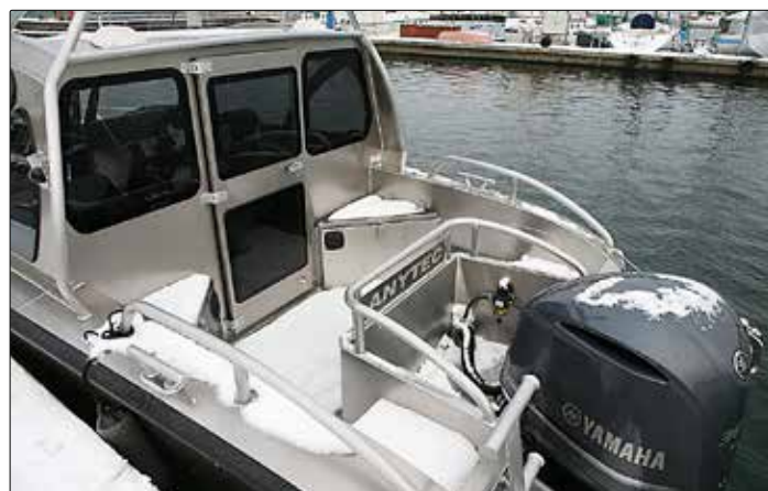
Liten, men smart utformad akterbrunn och ett riktigt bra skyddsräcke (= handräcke) runt motorbrunnen.
