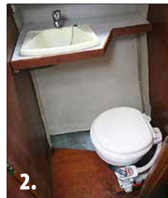
2. Den gamla vattentoan i vår Coronet 24, som skickar ut avfallet rakt i sjön, kommer att bli förbjuden under nästa år. En hålltank måste installeras i alla fritidsbåtar senast april 2015.
