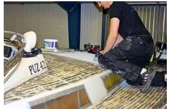
2. Däcket renslipas och görs klart för mallning av nytt teakdäck.
