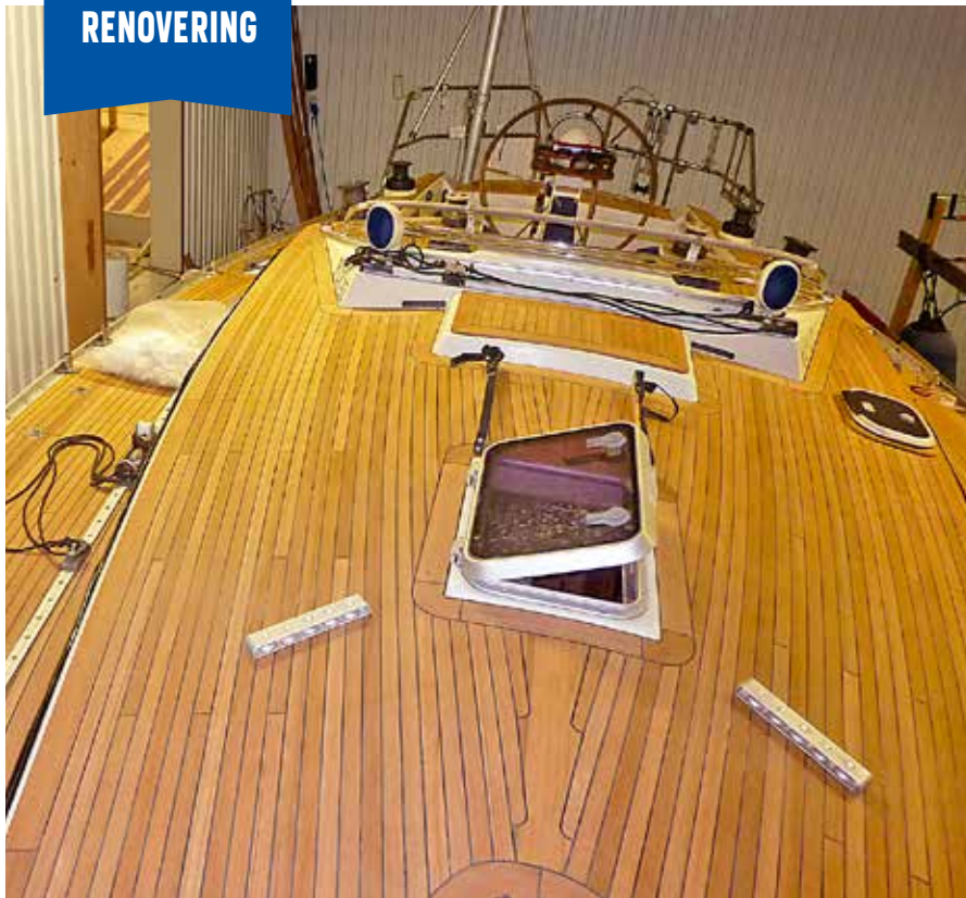
Hela däckets färdiglagt och alla beslag återmonterade. Inte en enda skruv så långt ögat når.
