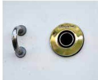
Väljer man en dieselsvärmare och har en dieseltank ombord är det enklast att ta detta bränsle via detta "dykrör". Ett hål borras på tankens ovasida och röret kapas av så att dess undre del hamnar minst 3 cm ovanför tankens botten.
