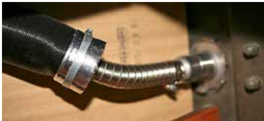
Avgasslangen är till största delen isolerad med ett hölje för att undvika brännskador. Innan slangen dras ut genom skrovsidan låter man den gå i en uppåtgående böj och får på så vis ett effektivt "lås" så att inte vatten kan rinna in bakvägen.
