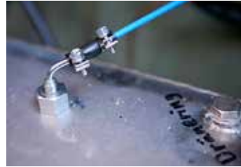
Väljer man en dieselsvärmare och har en dieseltank ombord är det enklast att ta detta bränsle via detta "dykrör". Ett hål borras på tankens ovasida och röret kapas av så att dess undre del hamnar minst 3 cm ovanför tankens botten.
