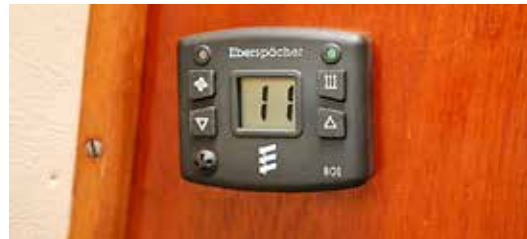
Manöverpanelen skall monteras inne i båten, och vi valde en modell med digital visning. Detta ger alltid en bra koll på båtens invändiga temperatur (här 11 grader) och är lätt att justera in till den temperatur som man vill ha.
