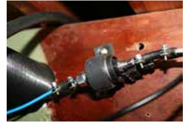
Från tanken dras ett bränslerör upp till en elektrisk pump. Denna skall monteras så nära tanken som möjligt och med utloppet pekande uppåt. Pumpen har ett speciellt gummifäste som reducerar ljud och vibrationer.
