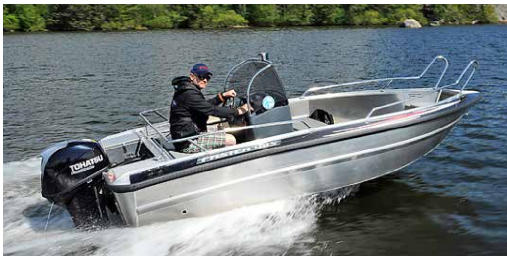
Faster 495i är godkänd för max 60 hk och sex personers belastning. Båten saknar steglister och går mjukt i sjön. Maxfarten med Tohatsus nya 50 hk är drygt 30 knop. Båten har hydraulstyrning som standard.
