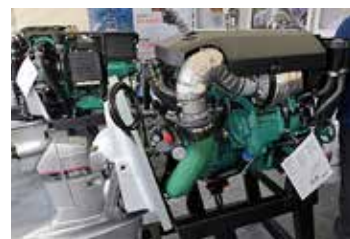
Volvo Penta har tagit fram en konverteringssats för att montera D3-motorn på ett befintligt 290-drev med sköld. Motorn finns med effekterna 170, 200 eller 220 hk. Pris 180 000 kr för 170 hk inklusive reglage och instrument. www.volvopenta.se
