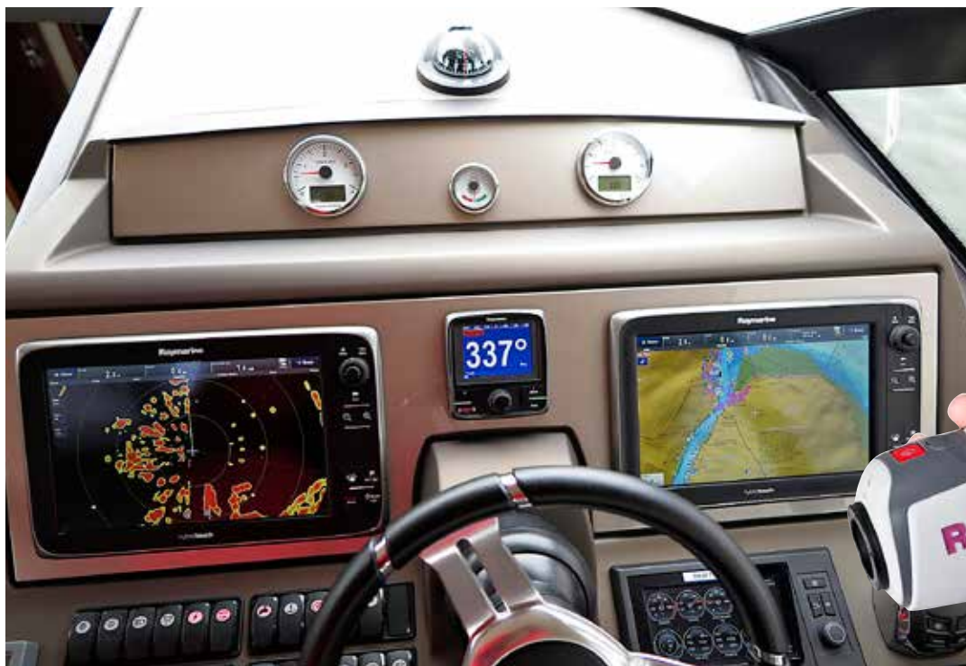
Raymarines nya autopilot Evolution i mitten kompletterad med två stycken tolv tums Hybridtouch skärmar.
