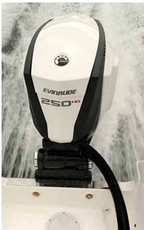
Det nya motorfästet gör att motorn står helt stilla. Inga sladdar eller kablar sticker ut ens när man svänger max.
