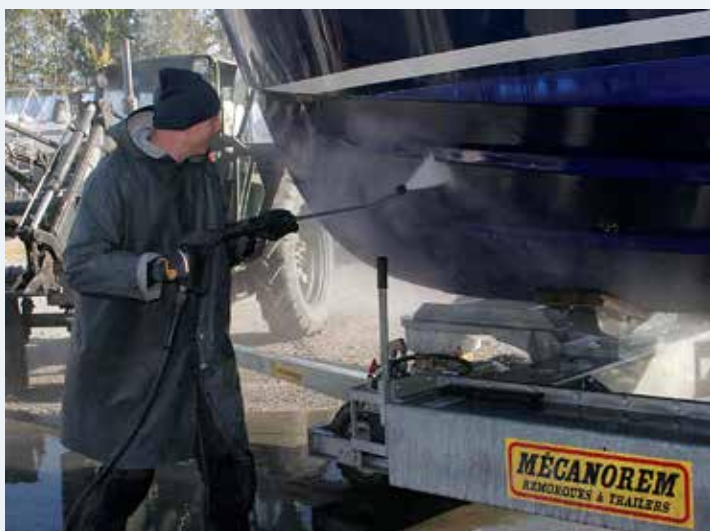
Fredrik Rosengren spolar botten med varmvatten.
