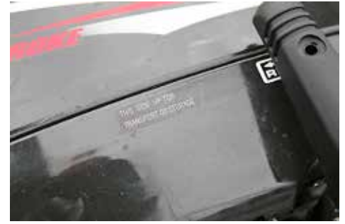
En fyrtaktare har olja i vevhuset. Oljan kan rinna upp i förgasare m.m. om motorn transporteras på fel sätt. En dekal visar vilken sida skall vara uppåt.
