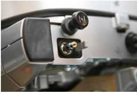
Nästan alla encylindriga utbordare från 4 hk och uppåt har en anslutning för separat tank.
