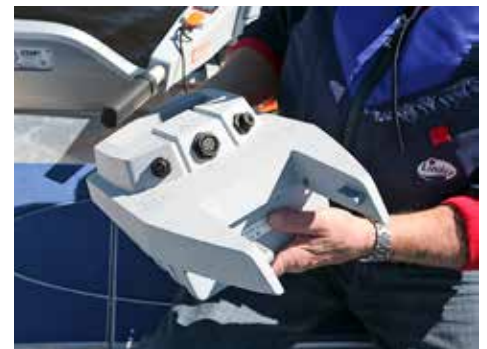
Torqeedo Travel 1003 har ett mycket smart batteripack på ovansidan som lätt kan tas av vid laddning.
