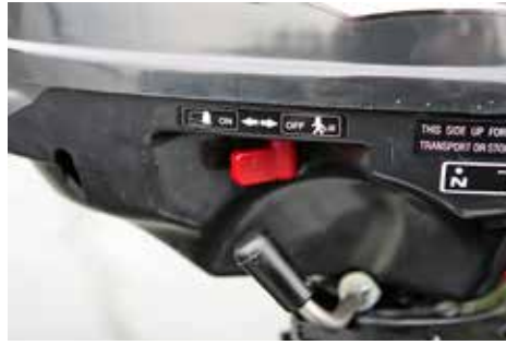
De flesta utbordare i denna storleksklass har en avstängningskran för bränslet i den inbyggda tanken.
