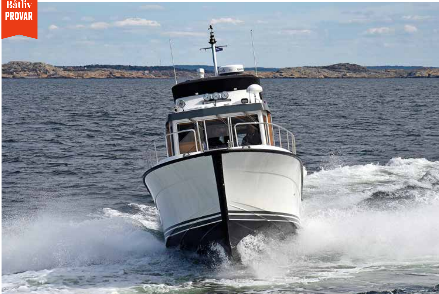
Targa 37 Fly med Humphree Control System. Båtens trimläge reducerades med 1,5 grad samtidigt som toppfarten (38 knop) ökade med drygt en knop med Humphree Automatic Trim Control.
