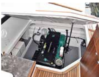
Motorluckan är tung men öppnas smidigt med elhydraulik.
