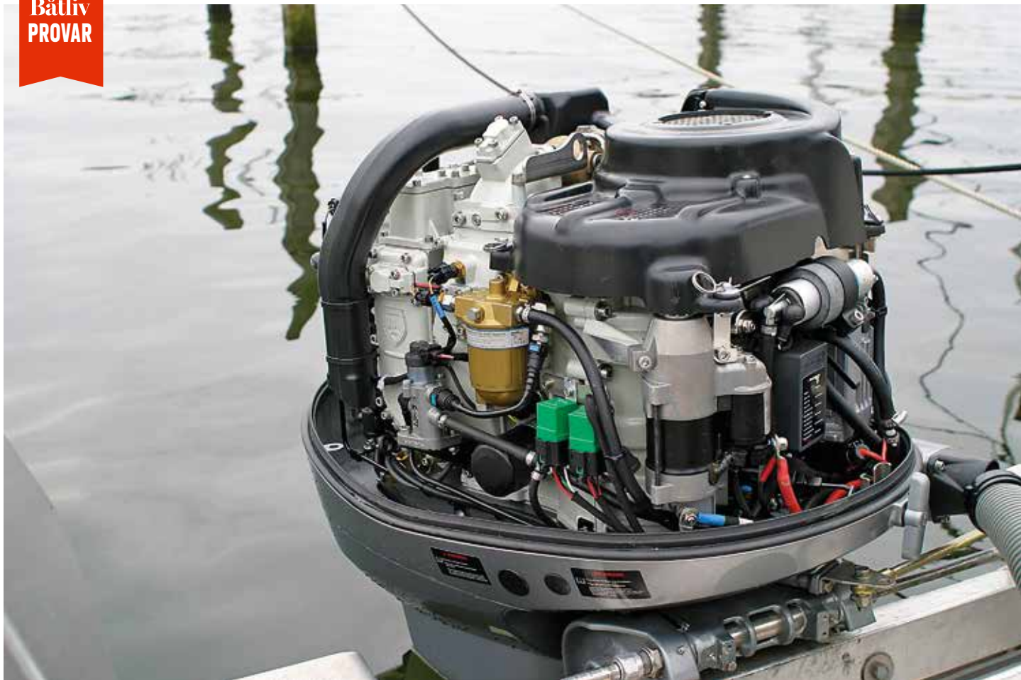
Motorns högra sida med bland annat startmotor, bränslepumpar, oljefilter och insug till turbon.
