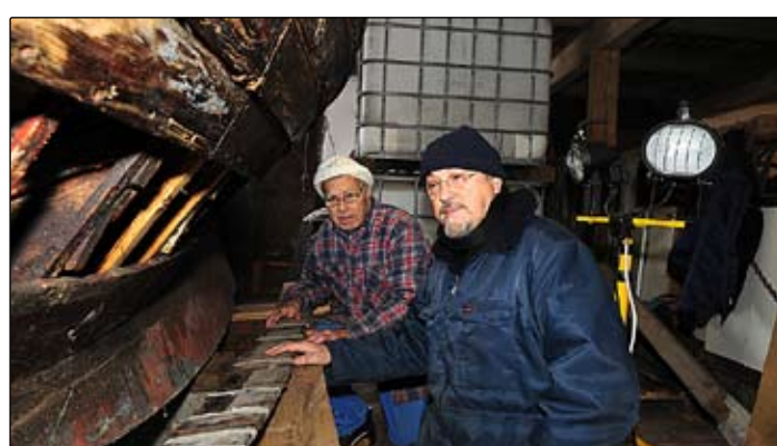
Jimmie Jackler (t. v.) och Bertil Alvertorp byter bord i en segelbåt byggd i mahogny och ek med blyköl.
