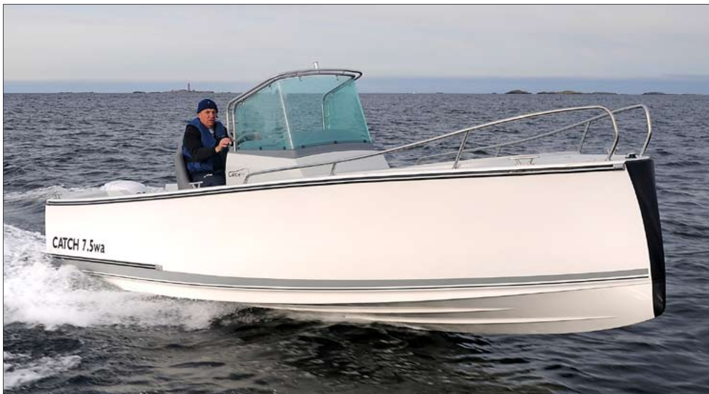
Catch 7.5 är en ny, miljövänlig båt som är anpassad för olika behov. Den passar lika bra som transportbåt eller som fiskebåt. Designen är speciell med ett vasst förskepp som klyver sjön och ett långsmalt, lättdrivet skrov.
