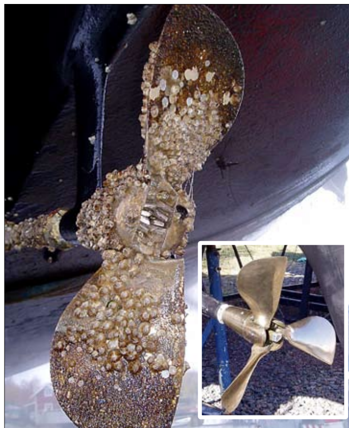
Med bevaxning sjunker verkningsgraden åtskilliga gånger. En ren propeller (infälld) är mycket effektivare i vattnet.
