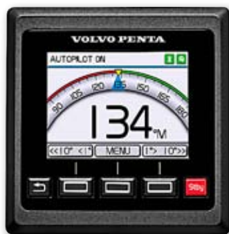
Volvo Penta autopilot är integrerad i EVC-systemet så att den startar automatiskt.
