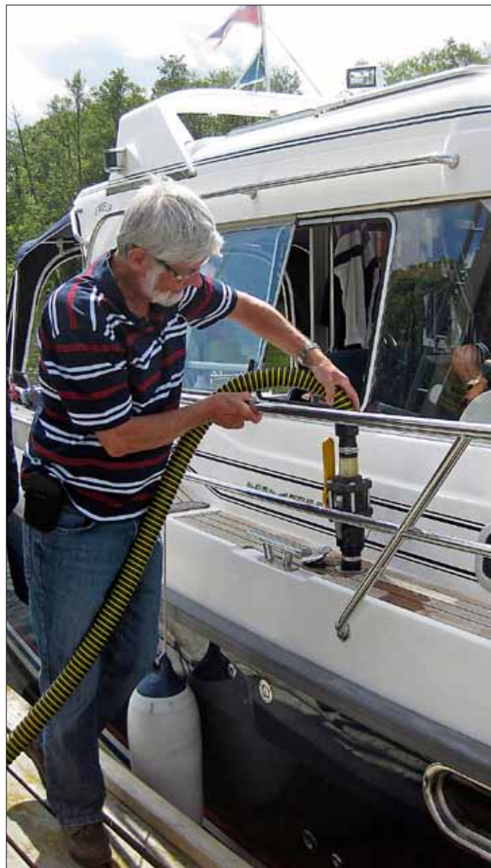
Så här enkelt är det! Bo Ljung, motorbåtsägare och medlem i Stäkets motorbåtssällskap, visar hur lätt det är att tömma hålltanken.
