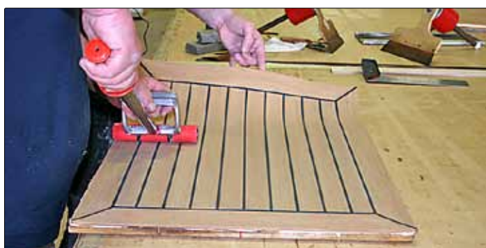
Med hjälp av särskilda verktyg pressas nya durken på det nylimnade underlaget.
