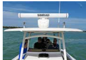
Simrad Halo radar är en så kallad solid state enhet, som inte behöver någon uppvärmning utan startar direkt.
