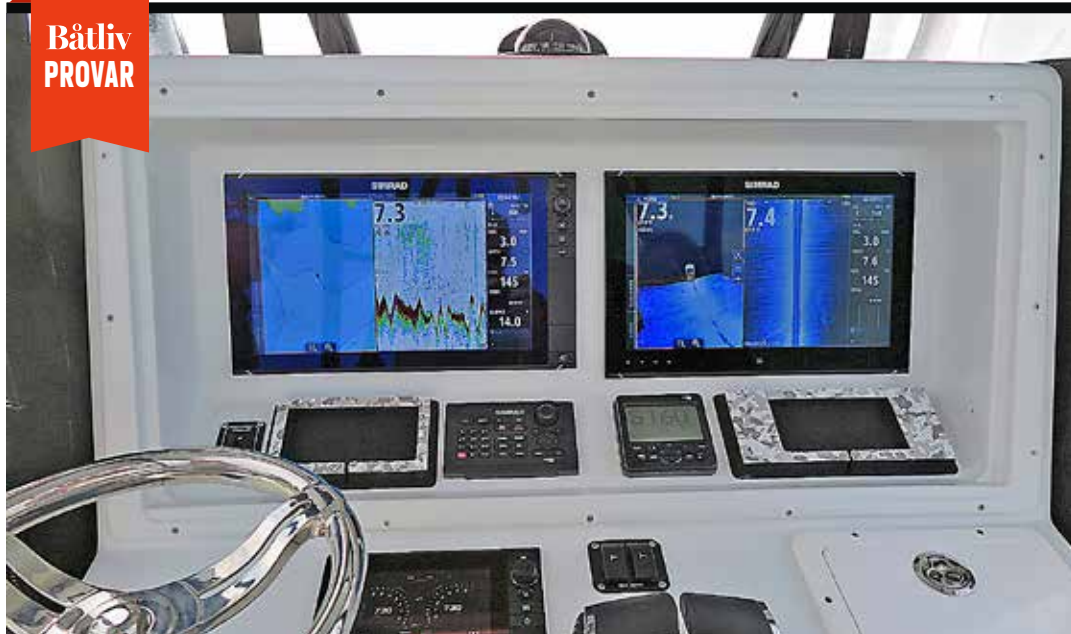
Simrad Halo radar är en så kallad solid state enhet, som inte behöver någon uppvärmning utan startar direkt.
