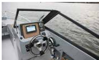
Perfekt förarplats med hydraulstyrning, bra fotstöd och små stuvfack.
