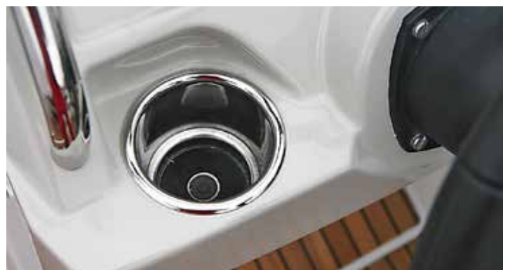
Burkhållare är standard och en liten finess är att samtliga har en dränering i botten via slangar.
