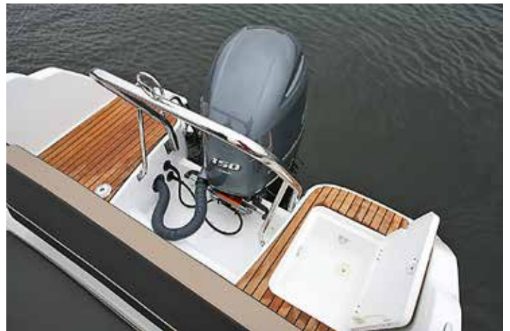
Breda badplattformar med steg om styrbord och ankarbox om babord. Vattenskidbåge är extrautrustning.
