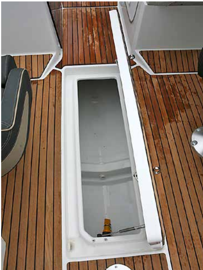
Jättefack mitt i båten för extra långa prylar. Notera att kanten runt luckan har en avrinning.
