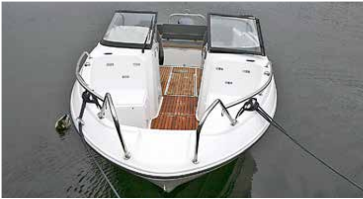
"Nordiskt" insteg med delad stävpulpit och "trappsteg" ner till durken.
