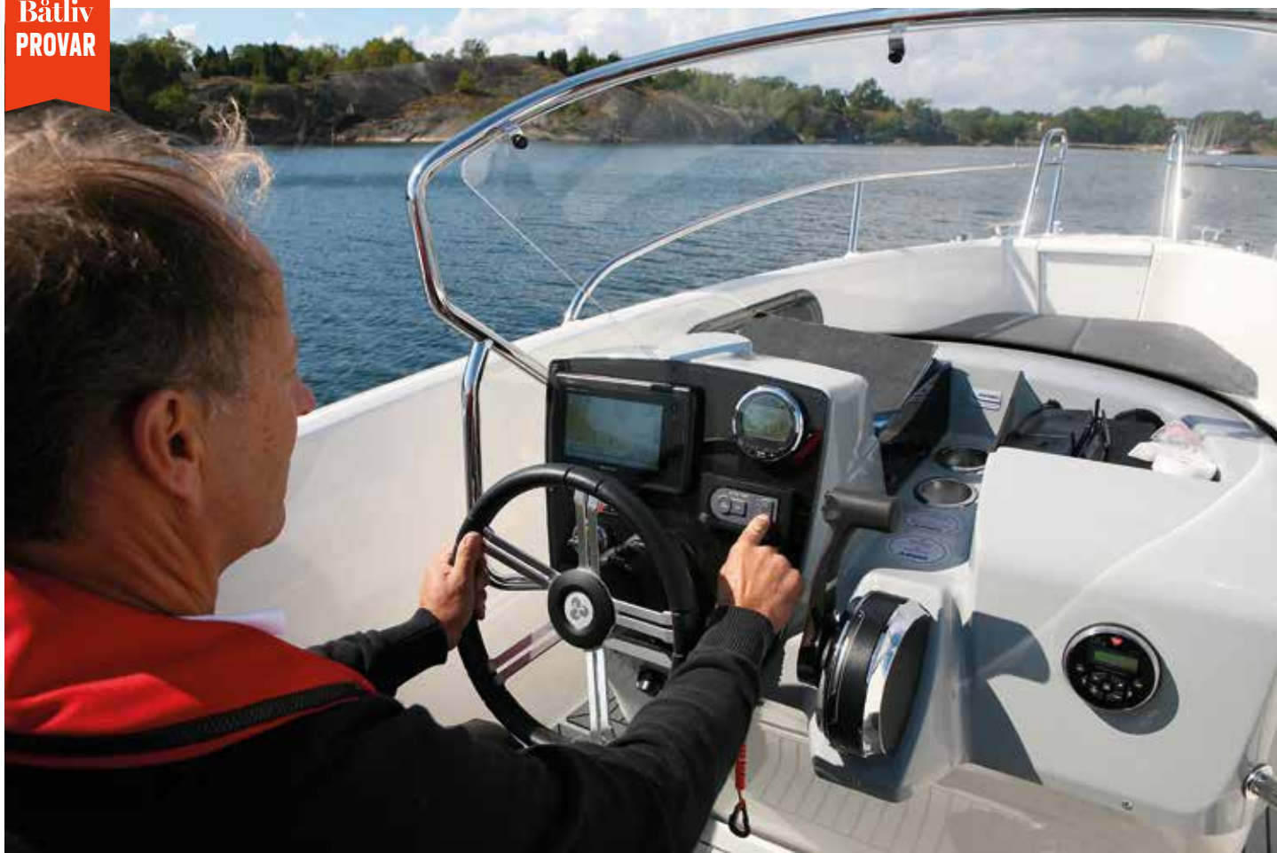
Manöverpanelen bör placeras vid förarplatsen så att man lätt kan göra finjusteringar under gång vid olika väderförhållanden.
