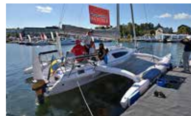
Cruze 970 är en spännande trimaran, som byggs i Vietnam. Båten fungerar fint som snabb familjeseglare och kan fällas ihop av en person och transporteras på trailer. Mått 9,7x6,88 m. Vikt 1 800 kg. www.corsairmarine.se
