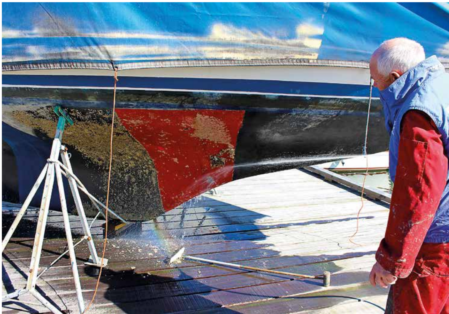
När Vindö 32:an togs upp var det enkelt att rengöra den röda ytan som målats med silikonfärg. Även denna yta fick beväxning, men den var enklare att göra ren.
