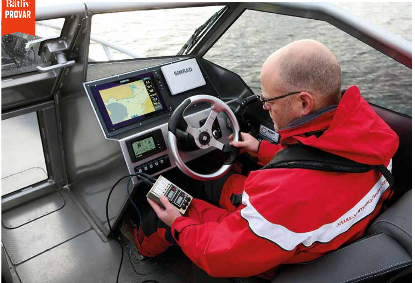
Våra bränslemätningar genomfördes vid flera olika farter från 15 knop och uppåt. Här med en Yamaha F300 som kontrolleras av Daniel Dellgar, produktansvarig för Yamahas utbordare på den skandinaviska marknaden.
