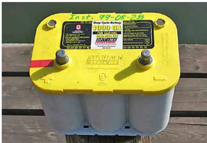
Detta AGM batteri installerades 1999 och ersattes först 2016 med ett nytt. 17 år i drift utan underhåll.
