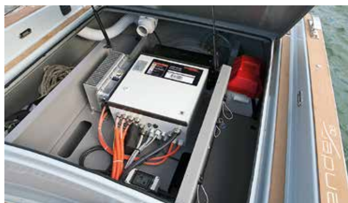
Elsystemets "hjärna" är en så kallad Deep Blue Connection Box dit all elektronik och batterikablar är anslutna.
