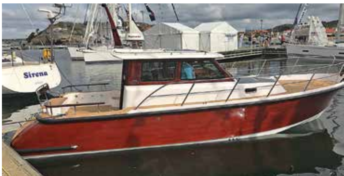
Vindö Rapid Commuter 32 från Vindö Marin AB hade världspremiär. Det är en båt i samma stil som den Vindö 29 Rapid Commuter Båtliv skrev om 2008. Båten är ritad av Rolf Eliasson och den första båten är byggd med skrov av kallbakad mahogny.
