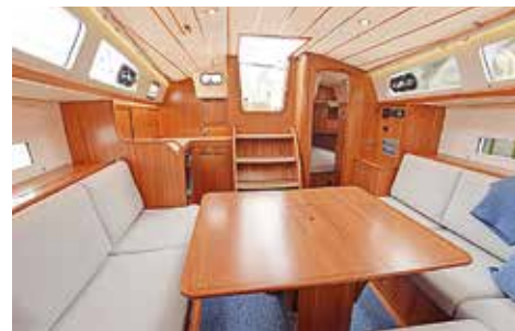
Salongen är placerad där skrovet är bredast. Lösningen gör också att maststötten inte är i vägen.
