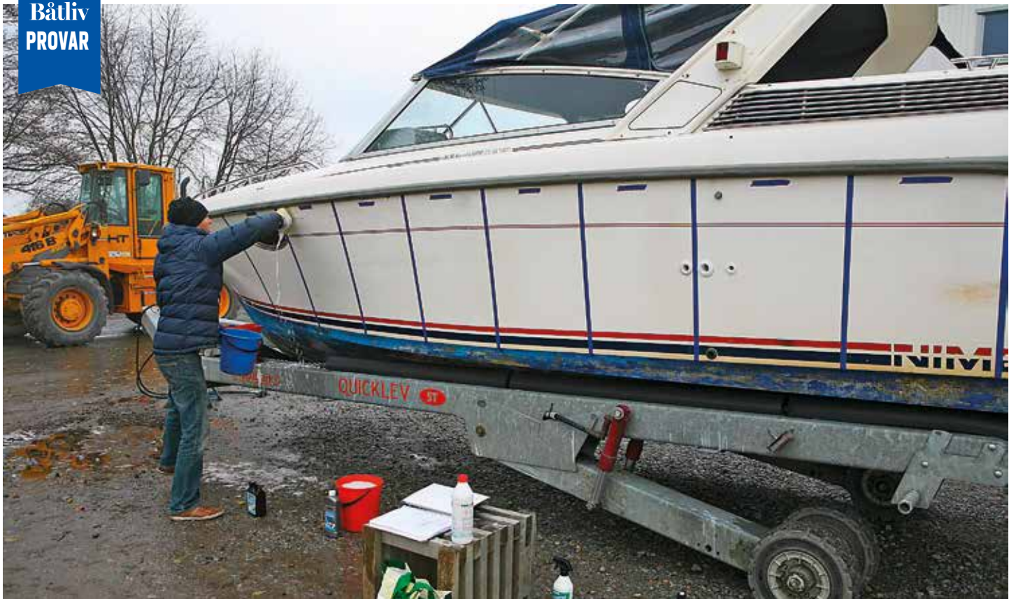
En Nimbus 26 som skulle vinterförvaras var vår "testbänk". Babordssidan delades upp i ett antal fält och här testade vi våra åtta rengöringsmedel.
