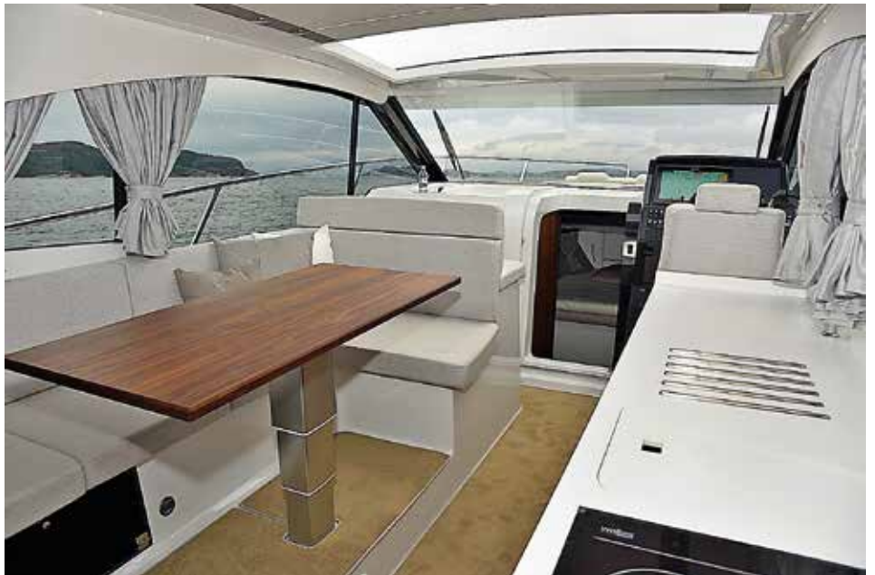
Salongen är ljus och luftig. Fönstertyrorna är stora och i taket sitter en elmanövrerad glaslucka.
