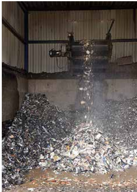
Efter fragmenteringen med en 32 ton tung rotorhammare återstår bara småbitar.
