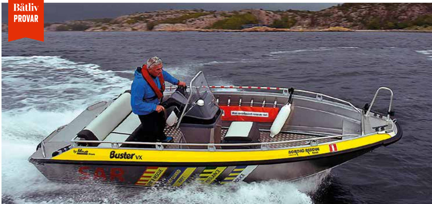
Nordic Rescue SAR Boat är ett lätt alternativ till en större båt. Det är en Buster LX som har modifierats med drivenhet från en vattenskoter. Båten gör 45+ knop och tvärnitar på ett par båtlängder.
