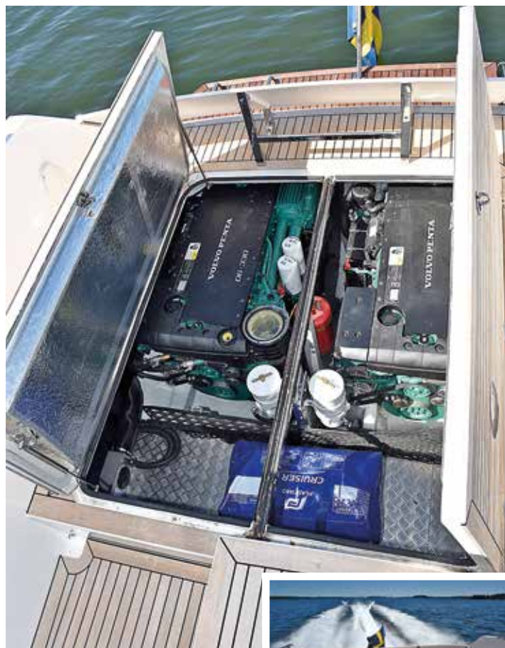
Motorrummet i versionen med inombordare är fullmatat.
