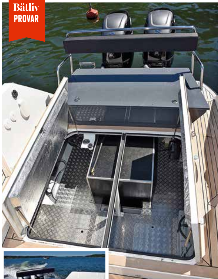
"Motorrummet" med utombordare ger extra stuvutrymme.
