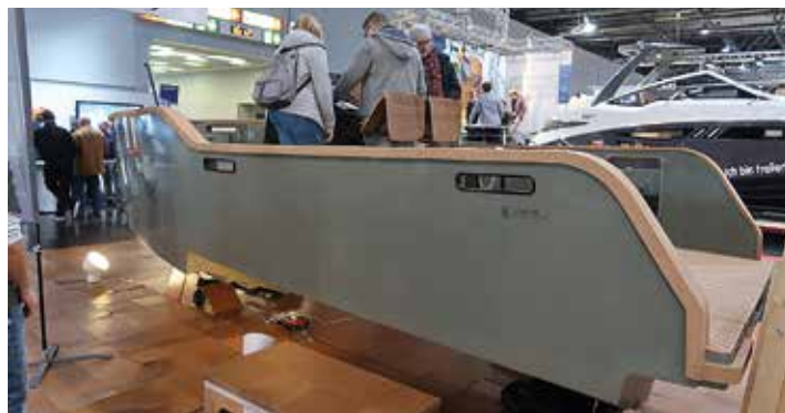
Eelex 6500 är på 6,5x2,4 m och väger 1 800 kg. En laddning tar åtta timmar med 360 V och tolv timmar med 220V. www.xshore.com
