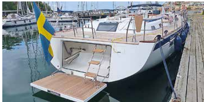
När aktern öppnas kommer badplattformen fram, med ett stuvutrymme.
