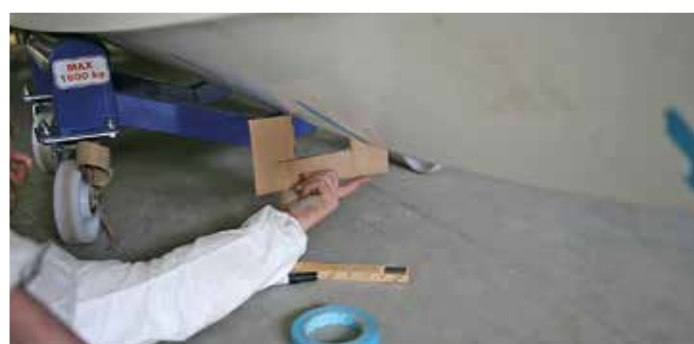
2. Tunneln får inte vara kortare än 92 mm i underkant (varierar mellan olika modeller). Skär till en mall i papp med en bredd på 100 mm (= lite marginal), håll upp mot skrovet och markera var hålen ska borraras för fräsverktygets cylinderstång.
