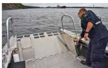
Fördäcket är en rejäl arbetsyta med fällbar ramp, vinsch med mera.
