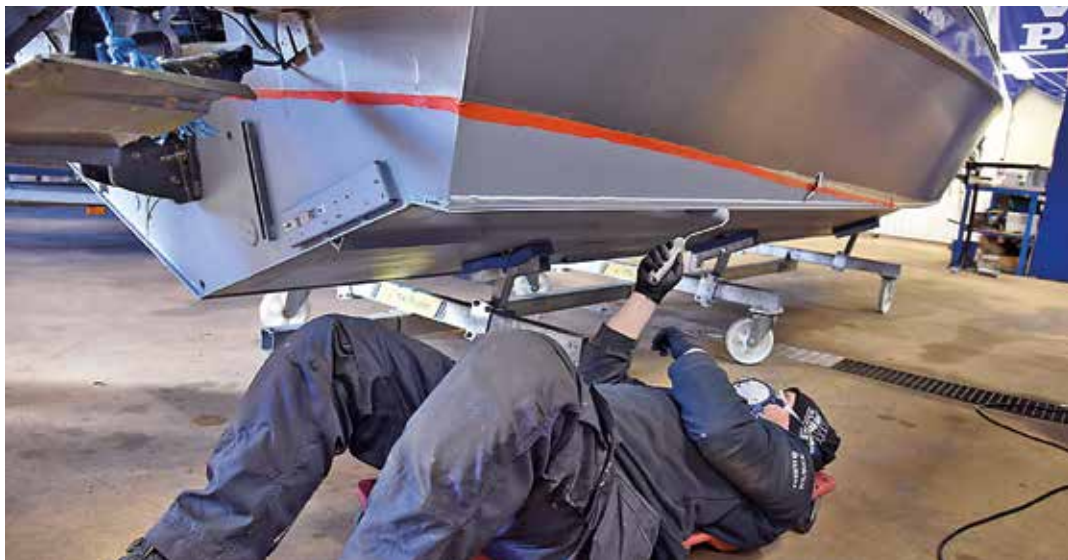
Målningen av botten med den biocidfria färgen gjordes inomhus. På bilden till vänster läggs primern på.
