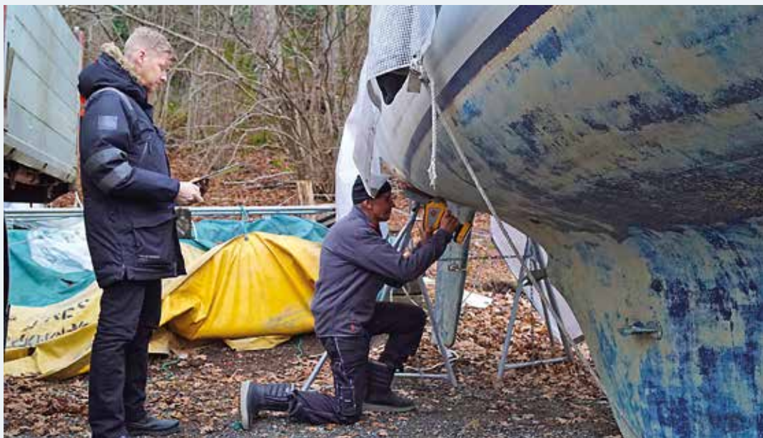
XRF-mätning på båtskrov hos Saltsjöbadens Båtklubb.
