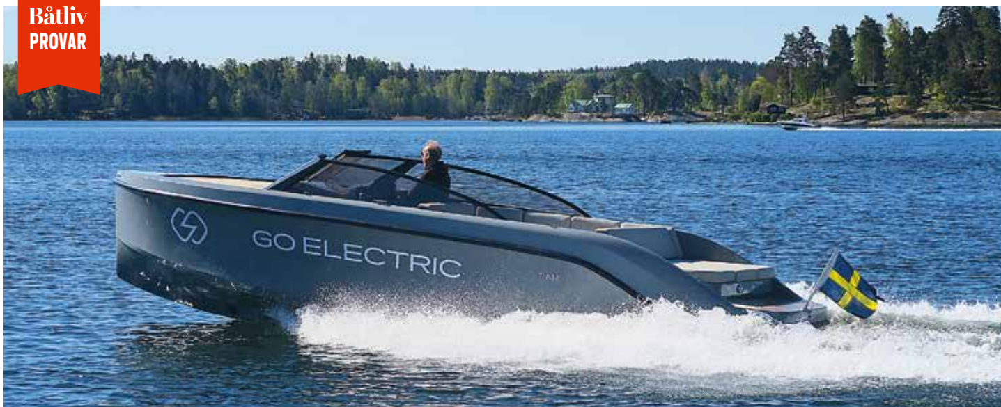
Rand Leisure 28 Electric är helt eldriven med cirka 25 M räckvidd i 20–24 knop.
