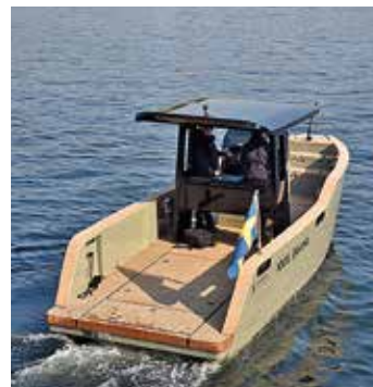
Däcket på Eelex 8000 2021 Edition kan anpassas för olika aktiviteter, men det finns inga övernattningsmöjligheter i den här versionen. Skrovet är 2,56 m brett och har bra bärighet.
