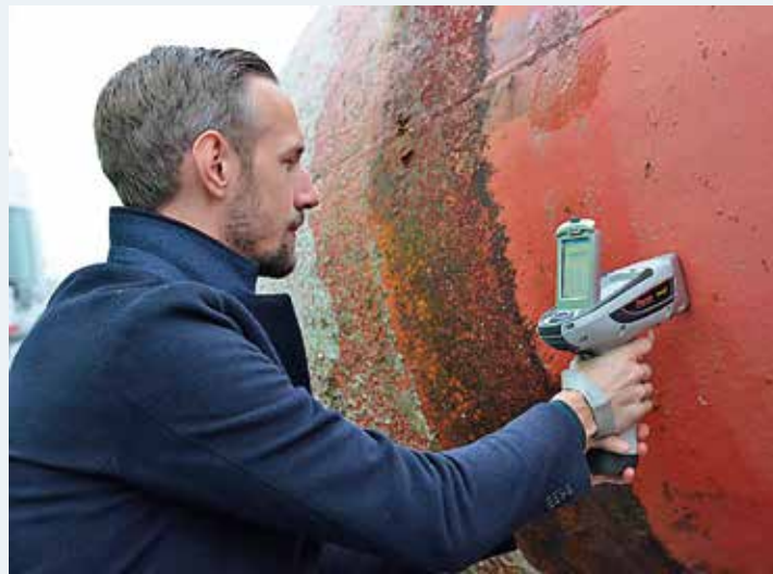
Carl Rönnow provar XRF-mätningar på en båtbottn.
