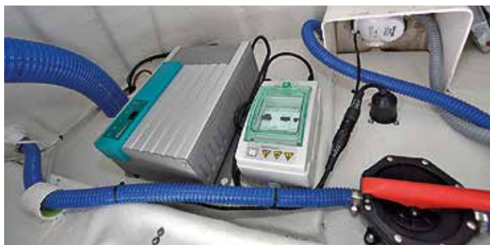
Mastervolt har levererat hela elsystemet inklusive motor och elkablar. Allt får plats under den plana durken.
