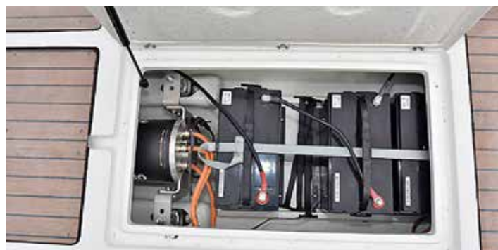
Mastervolt har levererat hela elsystemet inklusive motor och elkablar. Allt får plats under den plana durken.
