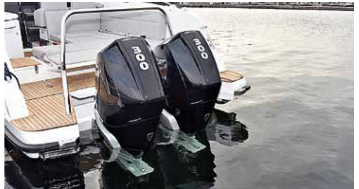
Två V8 från Mercury på vardera 300 hk gav båten en toppfart på över 50 knop.
